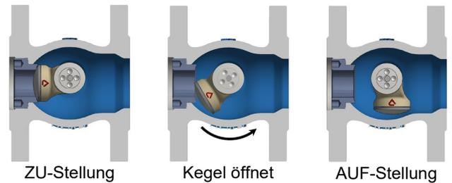
Bild 3: Kegelbewegung bei doppel-exzentrischer Lagerung
