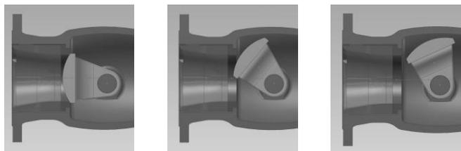
Bild 3: Kegelbewegung bei doppel-exzentrischer Lagerung
