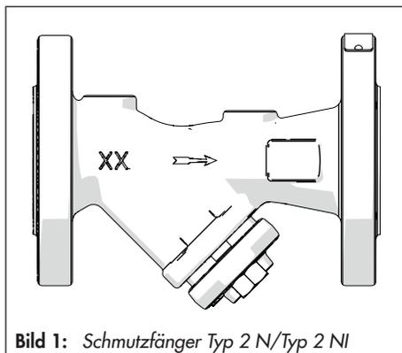
Bild 1: Schmutzfänger Typ 2 N/Typ 2 NI
