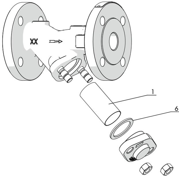
**Bild 2:** Ersatzteile im Ersatzteilkit
