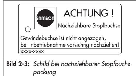
**Bild 2-3:** Schild bei nachziehbarer Stopfbuchspackung
