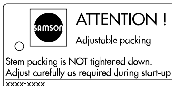
Fig. 4: Etikett när en justerbar packning har installerats
