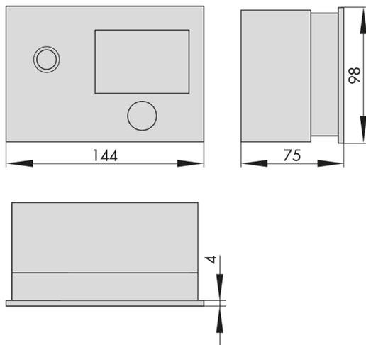
**Bild 3-2:** Maße in mm · Regler mit hohem Gehäuserückteil
