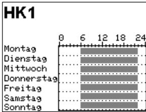
Drehschalter auf die Schalterstellung „Nutzungszeiten“ drehen. Der erste Regelkreis wird zusammen mit den aktuellen Nutzungszeiten angezeigt.
