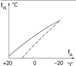
**Steigt die Raumtemperatur in der Übergangsjahreszeit,** ist eine Verringerung des Niveaus und gleichzeitige Erhöhung der Steigung erforderlich.
