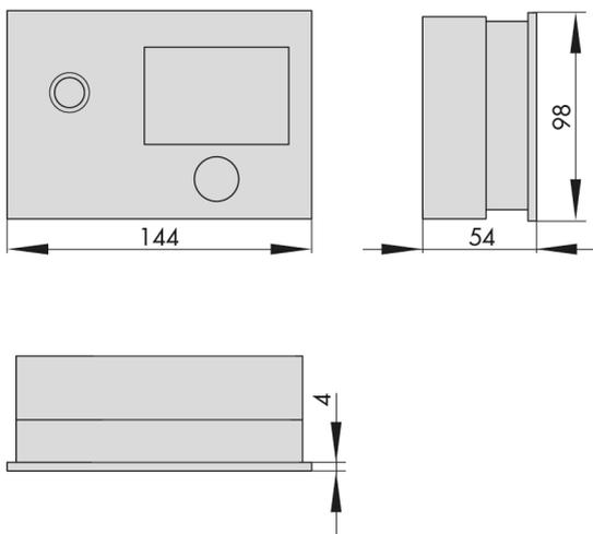
**Bild 3-1:** Maße in mm · Regler mit Standard-Gehäuserückteil
