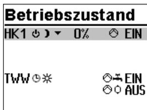
Drehschalter auf die Schalterstellung ☽☽ „Betriebsarten“ drehen. Es werden die Betriebszustände aller Anlagen-Regelkreise angezeigt:
