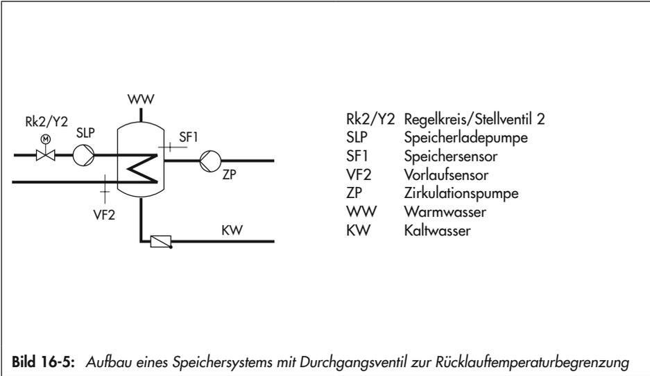
Durchgangsventil und Temperatursensor VF2 dienen in der oben dargestellten Schaltungsvariante ausschließlich der Rücklaufemperaturbegrenzung. Der Vorregelkreis stellt wie in der Standard-Schaltung mindestens eine Vorlaufemperatur zur Verfügung, die sich aus 'Sollwert Trinkwasser' + 'Überhöhung Ladetemperatur' + 'Überhöhung Sollwert Vorregelkreis' ergibt.
