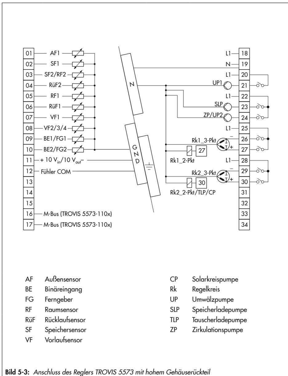
Bild 5-3: Anschluss des Reglers TROVIS 5573 mit hohem Gehäuserückteil
