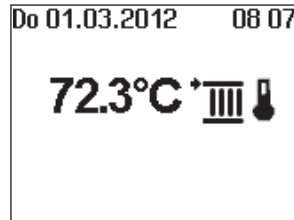
Festwertregelung Isttemperatur = Vorlauftemperatur
