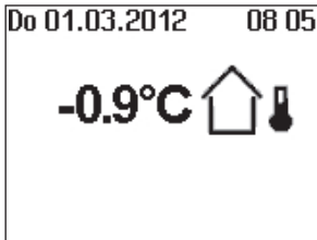
Witterungsgeführte Regelung Isttemperatur = Außentemperatur
