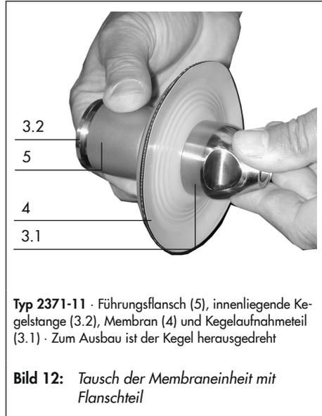
**Typ 2371-11** · Führungsflansch (5), innenliegende Kegelstange (3.2), Membran (4) und Kegelaufnahmeteil (3.1) · Zum Ausbau ist der Kegel herausgedreht
